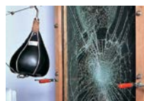
破壊試験状況 (ショットバッグ試験)
